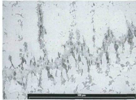
Eine aufgekohte Schweißnaht mit Schlackeneinschlüssen verbindet das Rückenmaterial mit dem ferritisch-perlitischen Schneidematerial.
