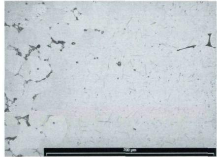
Links – feinkörniger Ferrit mit Korngrenzenperlit; rechts – Ferrit mit nadelförmigen Ausscheidungen (Nitride?)
