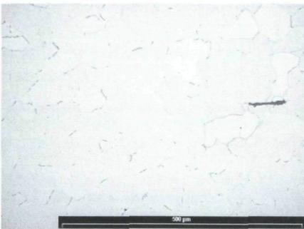
Probe-Spitze: Ferritisches Gefüge im Kern.
