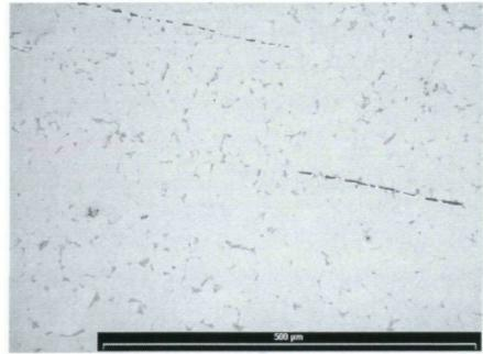
Ferritisch-perlitisches Gefüge im Klingenkern eingestreckte Schlacken.
